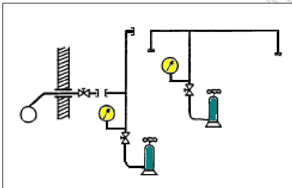
Εικόνα 10: Δοκιμή Αντοχής
