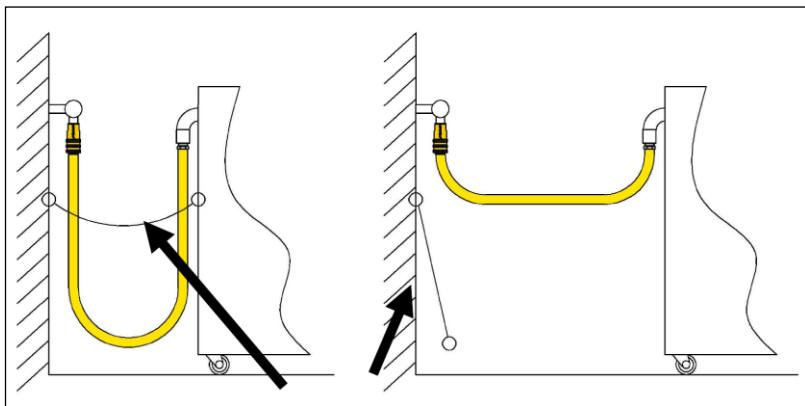
**Εικόνα 7: Συνδεσμολογία εύκαμπτου αγωγού σε τροχήλατη συσκευή αερίου – σωστή και λανθασμένη πρακτική**
