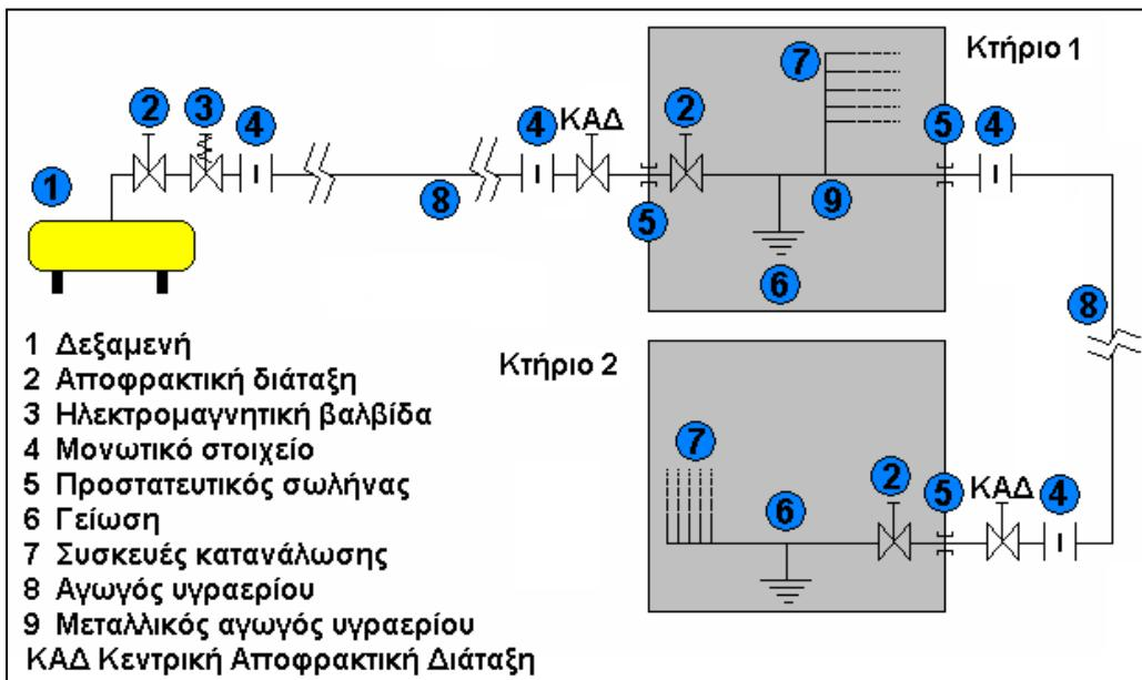
Εικόνα 9: Παράδειγμα διάταξης μονωτικών στοιχείων σε μεταλλικούς αγωγούς
