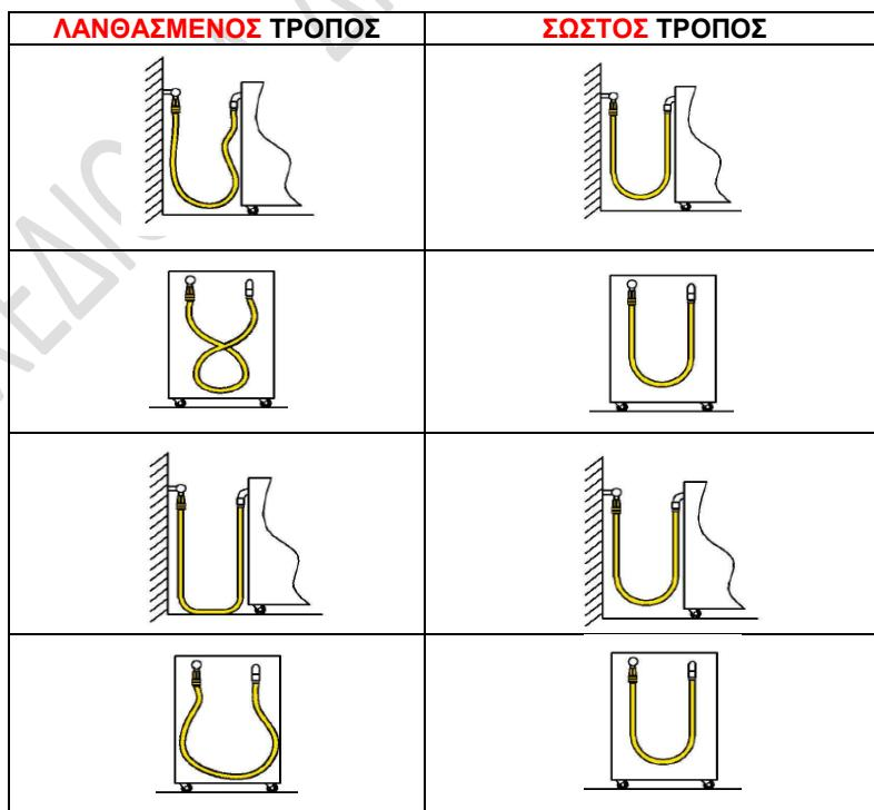
**Εικόνα 6: Λανθασμένος και σωστός τρόπος σύνδεσης του εύκαμπτου αγωγού σε συσκευή αερίου**
